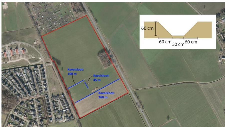
Ligging en schematische doorsnede bestaande kavelsloten
