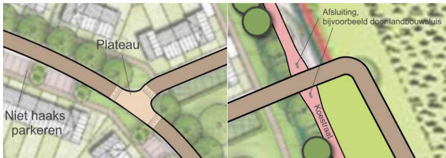
Aansluiting nieuwe ontsluiting aan Dille
