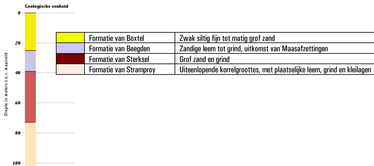
Figuur A: opbouw ondergrond.
