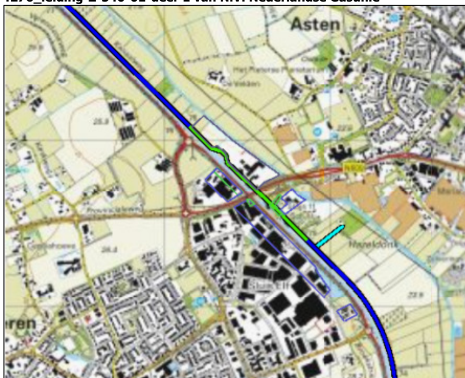
Figuur 4.1 Kilometer leiding behorende bij de maximale overschrijding van de FN-curve voor 4276_leiding-Z-540-01-deel-1 van N.V. Nederlandse Gasunie
