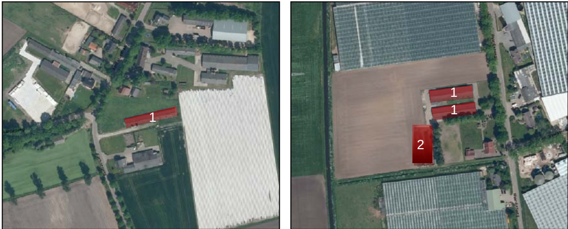
Figuur 27: Te slopen voormalige varkensstallen (1) en twee sleufsilo's (2) rood gearceerd (links: Antoniusstraat 61, rechts: Waardjesweg 68)
