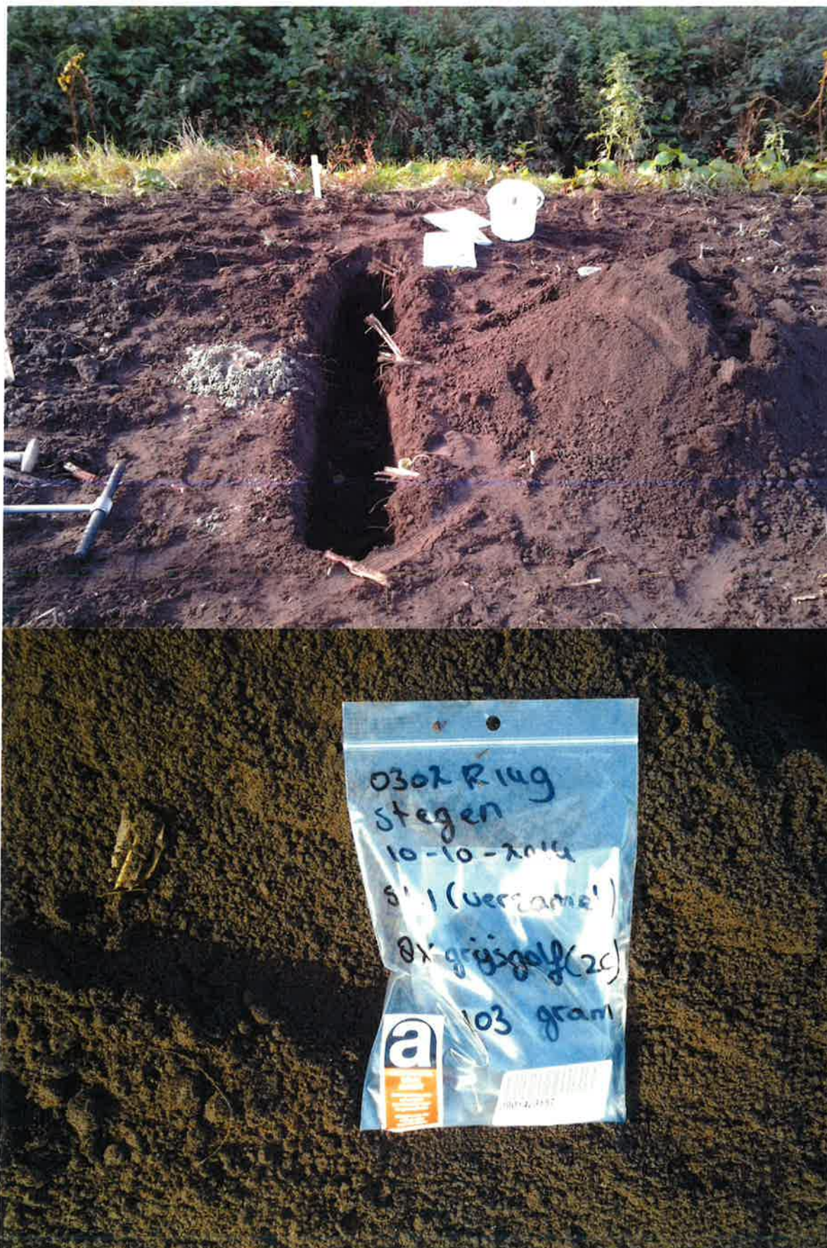
Foto van sleuf 1, met gevonden asbestfragmenten in de grove fractie – 10 oktober 2014
