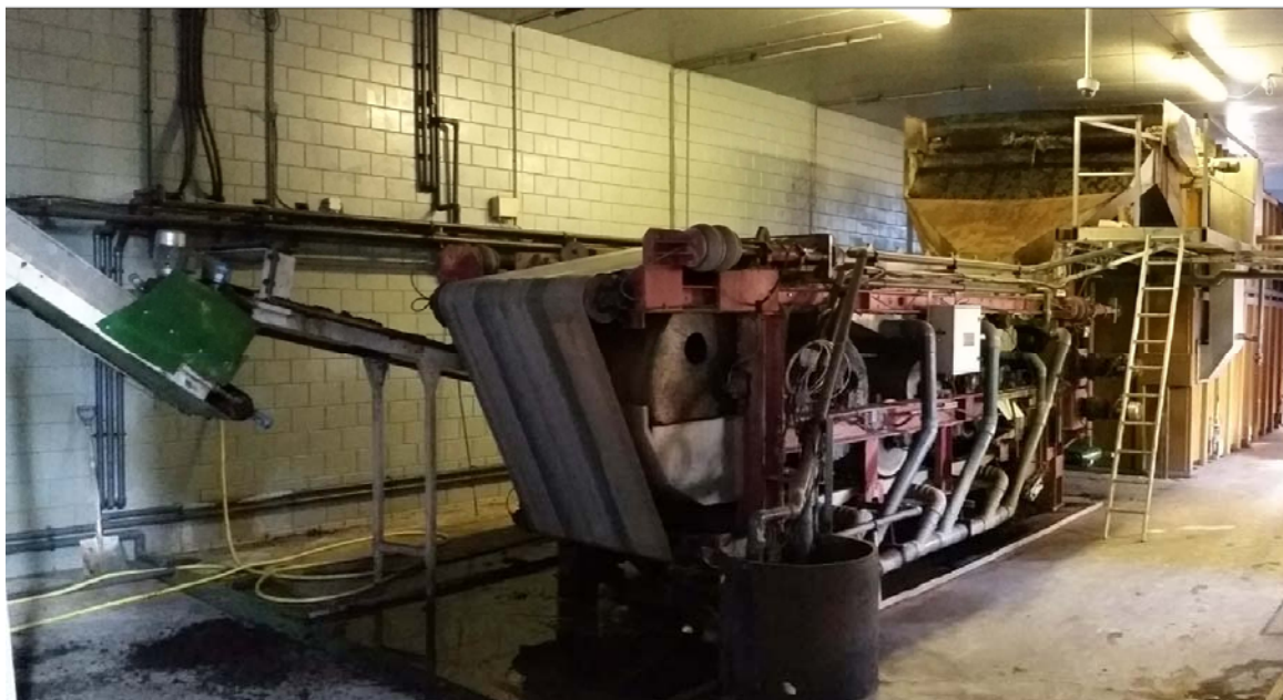
Figuur 2.5: Flotatie-unit met zeefbandpers
