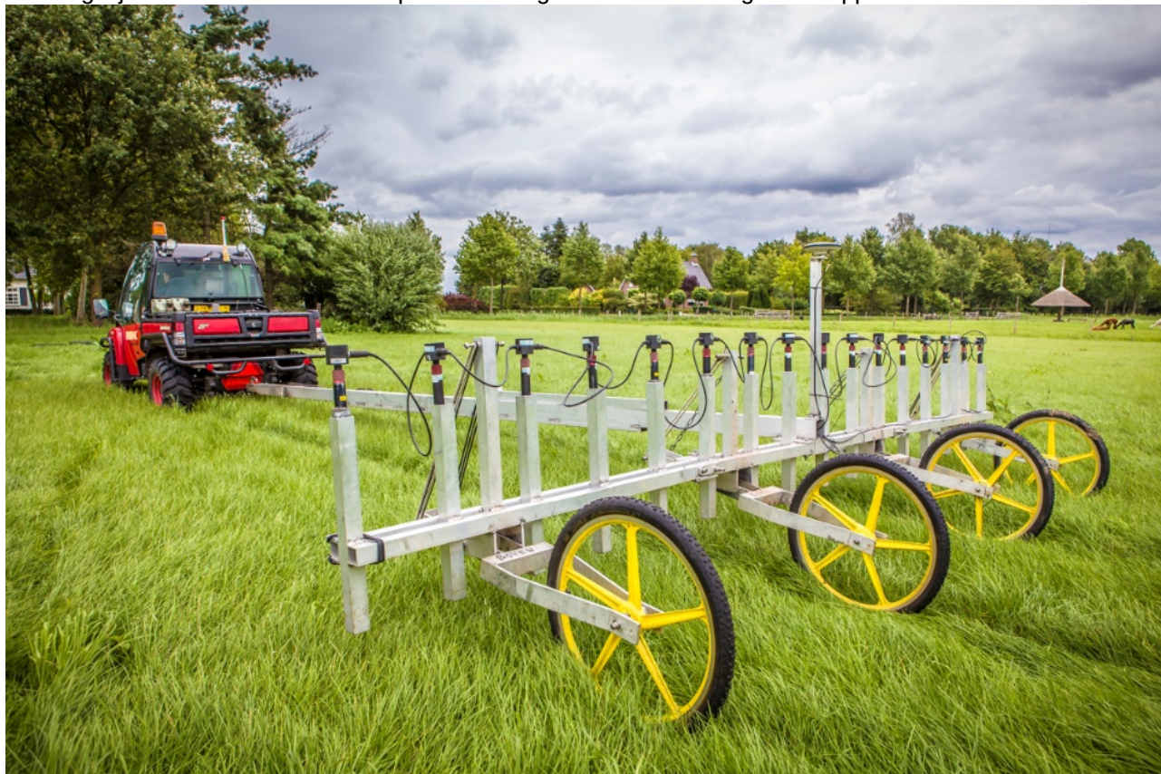
Afbeelding 9. Detectievoertuig zoals deze gebruikt is voor het uitvoeren van de passieve non realtime oppervlakedetectie.
