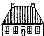
Figuur: Landarbeiderswoning met schilddak
