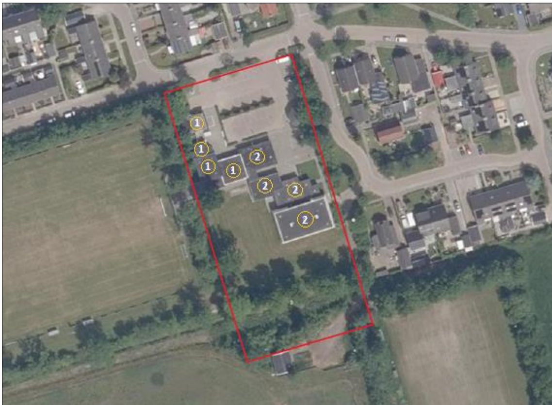
Figuur 1. Locatie van het onderzochte gebied (rood). Gebouwdelen met nummer 1 worden gesloopt. Gebouwdelen met nummer 2 blijven behouden. De sloot met nummer 3 wordt gedempt. Bron kaartondergrond: www.ruimtelijkeplannen.nl
