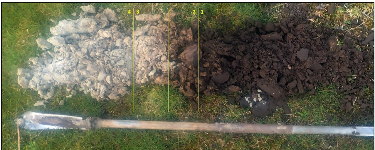
Afbeelding 15. Boorkern van boring 1. 1: bouwvoor, 2: omgewerkte grond, 3: dekzand, 4: keizand
