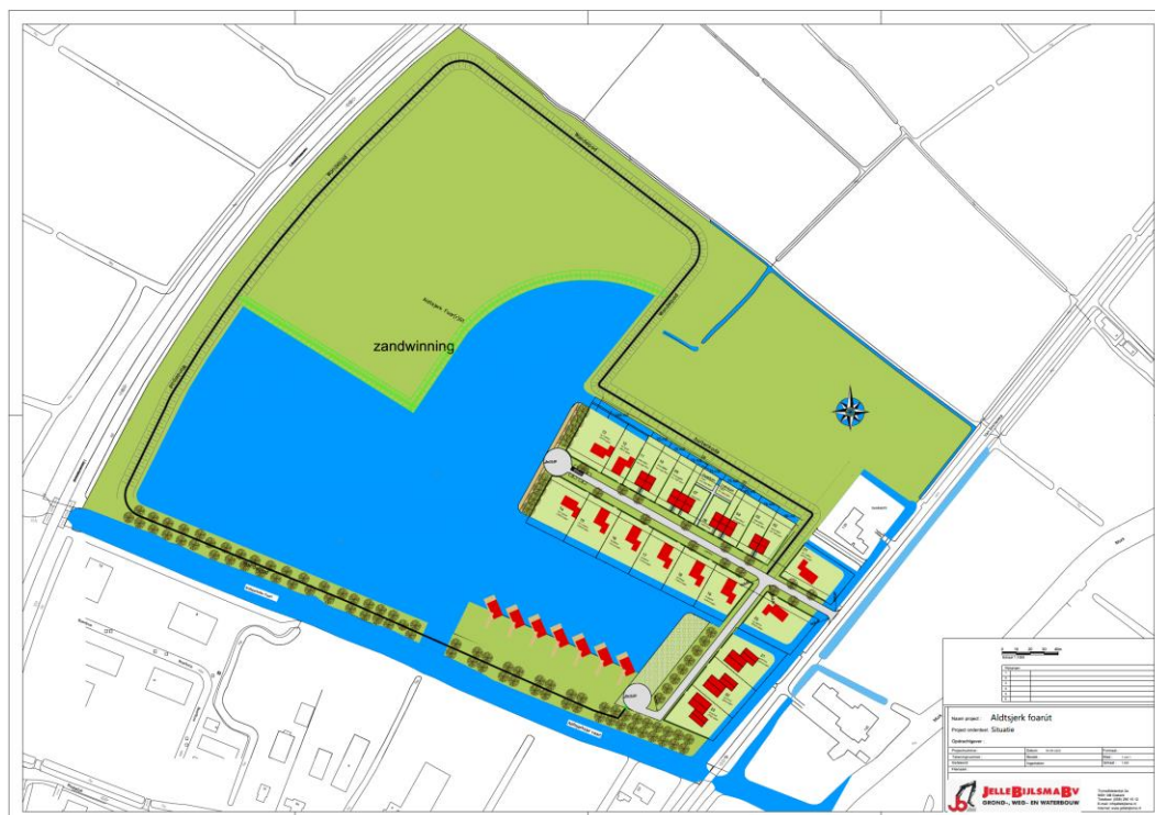
Figuur 3.5: Fase 3: voortzetting van de zandwinning
