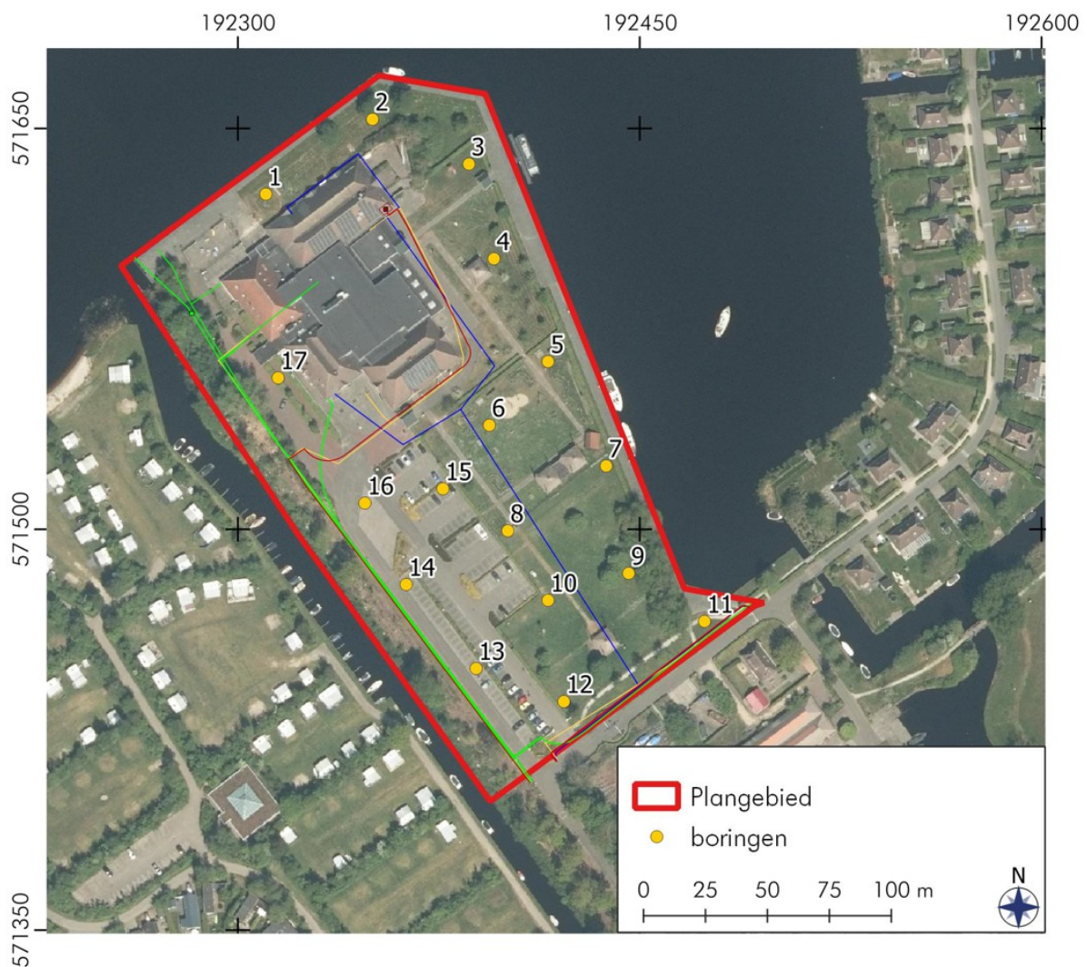
Figuur 9: Earnewâld, Koaidyk 8a: Overzicht met de boorlocaties. De begrenzing van het plangebied is met een rode lijn aangegeven. De boorlocaties zijn weergegeven met een genummerde cirkel. Als ondergrond is de kaart met de KLIC-gegevens gebruikt. De ligging van de aanwezige kabels en leidingen is hierop met gekleurde lijnen aangegeven.
