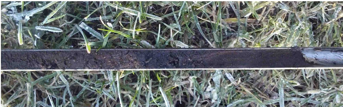
Figuur 5. Oentsjerk, It Aventoer. Foto van boring 2 met links het sterk veraarde veen en rechts direct het door humus en ijzer aaneengekitte zand dat de top van het dekzand vormt.
