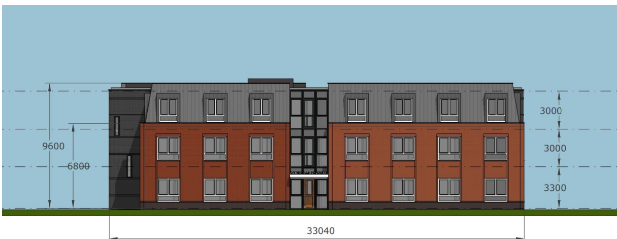
Vorgevel met goot- en nokhoogten, voorlopig ontwerp 2021-03-26
