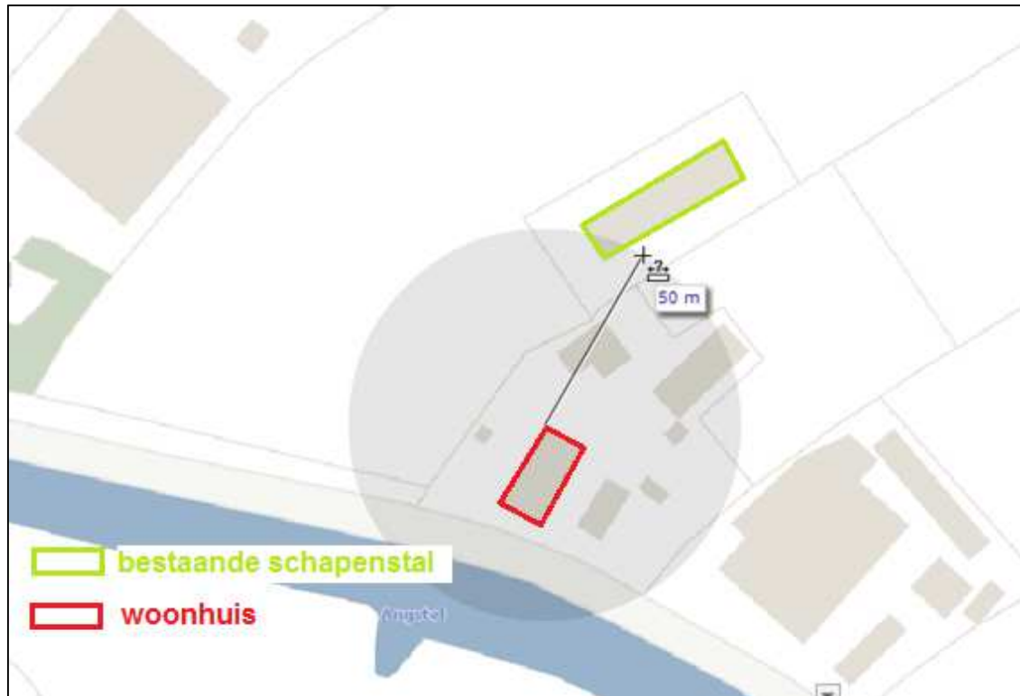
figuur 10: milieuzonering 50 meter vanaf gevel woning
