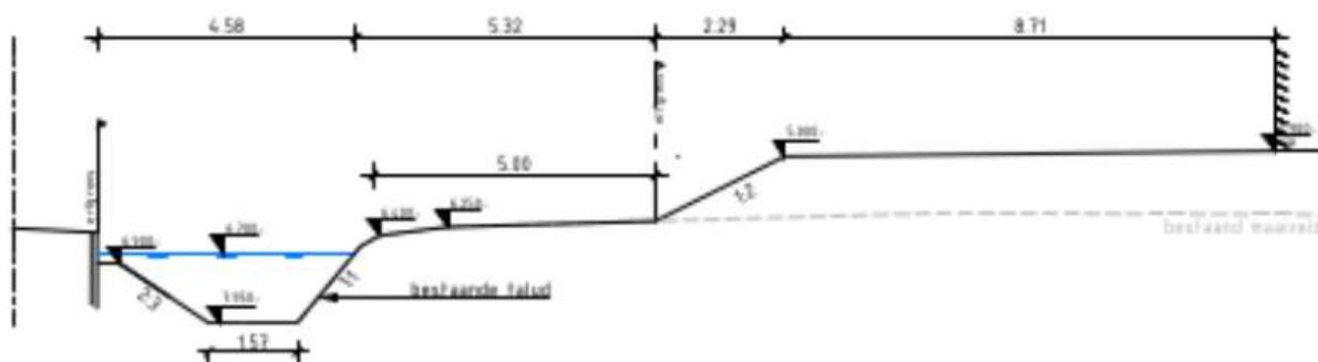
Figuur 3. Dwarsprofiel van de watergangen.
