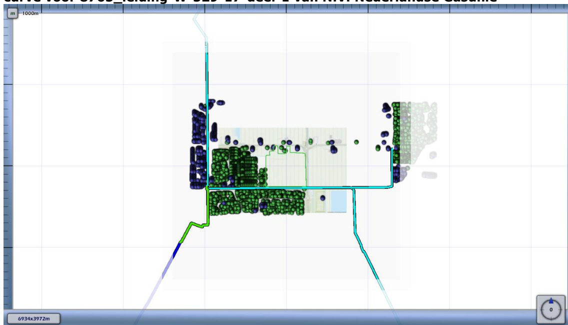
Figuur 4.4 Kilometer leiding behorende bij de maximale overschrijding van de FN-curve voor 8765_leiding-W-529-17-deel-1 van N.V. Nederlandse Gasunie
