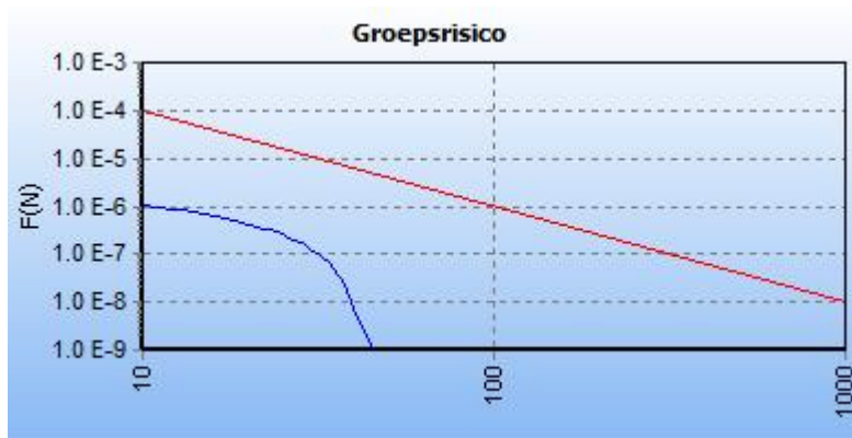
5.2 Figuur 5.2 FN curve voor 8765_leiding-W-529-03-deel-1 van N.V. Nederlandse Gasunie voor de kilometer tussen stationing 0.00 en stationing 0.00
