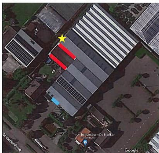
Figuur 1: Ligging geluidbronnen (rood = lichtstraat dak werkplaats en licht blauw = open overheaddeur; geel = open raam)
