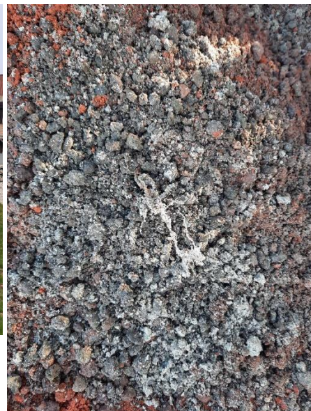
Foto 12: Vrijkomende gravel- en lavalithverhardingen ter plaatse van de tennisbanen.
