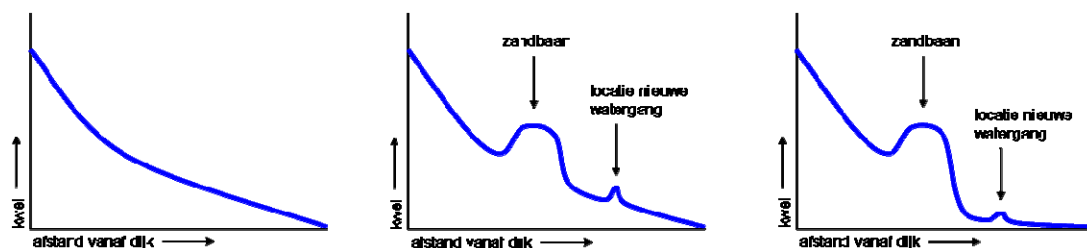
Figuur b1.2 Schematische weergave van: kwelverloop bij een homogene bodemopbouw (links), berekend kwelverloop bij aanwezigheid van een zandbaan en de wadi(midden), werkelijk kwelverloop bij aanwezigheid van een zandbaan en de wadi (rechts)
