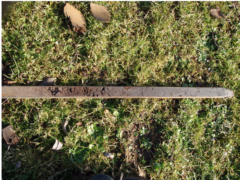
Figuur 3. Het uitgeboorde materiaal van boring 4 (tussen ca. 1,1 en 1,9 m -Mv). Van links naar rechts: oeverafzettingen, veenlaag en komafzettingen.
