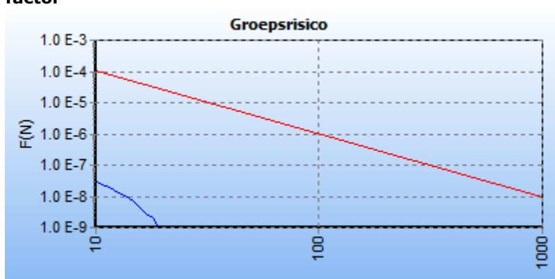
Figuur 4.2 Groepsrisico voor het segment W-528-01 met grootste overschrijdingsfactor
