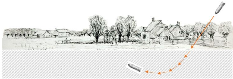
Figuur 29 Ondergrondse baan vliegtuigbom
