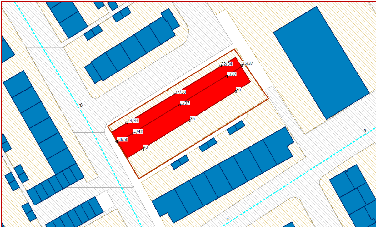
Figuur 4.3: Rekenresultaten geluidbelasting vanwege de 30 km/u wegen, inclusief 5 dB aftrek.
