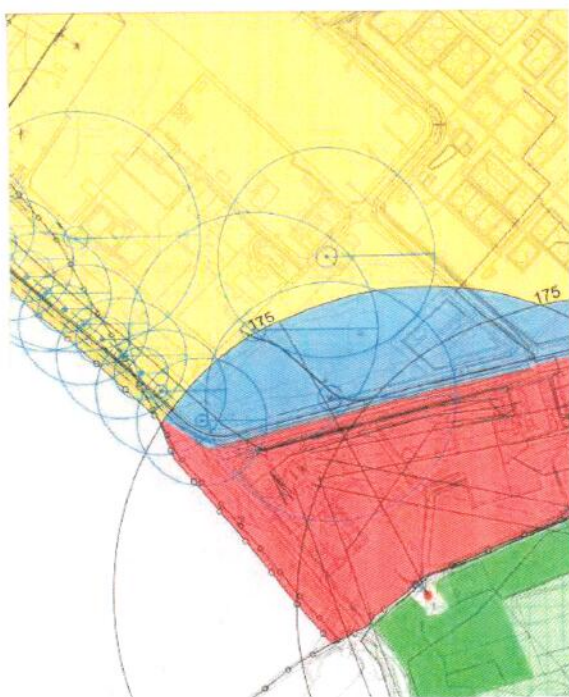
Figuur 1.2. Windturbines in het plangebied, ashoogte 78m rotordiameter 82m, tiphoogte 119m
