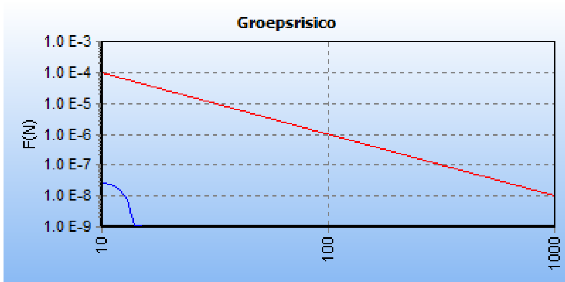
Figuur 5.1 FN curve voor bestaande leidingdeel van Enduris voor de kilometer tussen stationing 0.00 en stationing 1000.00:
