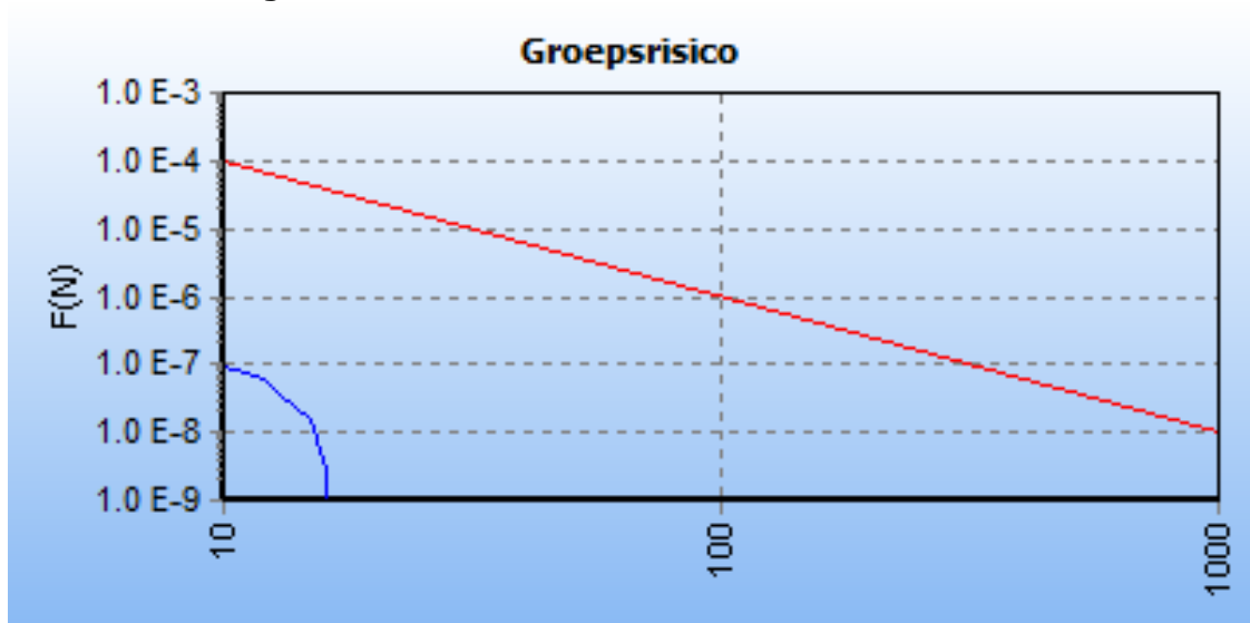
Figuur 5.2 FN curve voor het nieuwe leidingdeel voor de kilometer tussen stationing 0.00 en stationing 210.00:
