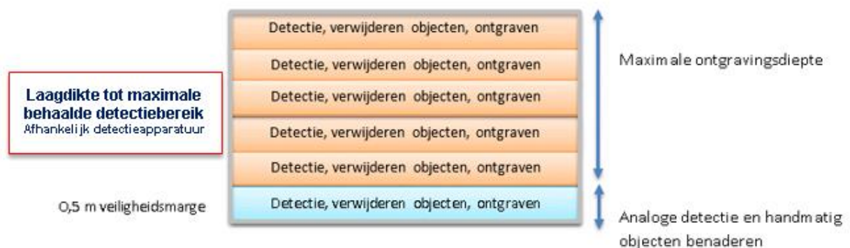
Figuur 62: Schematische weergave werkmethode laagsgewijze oppervlakedetectie
