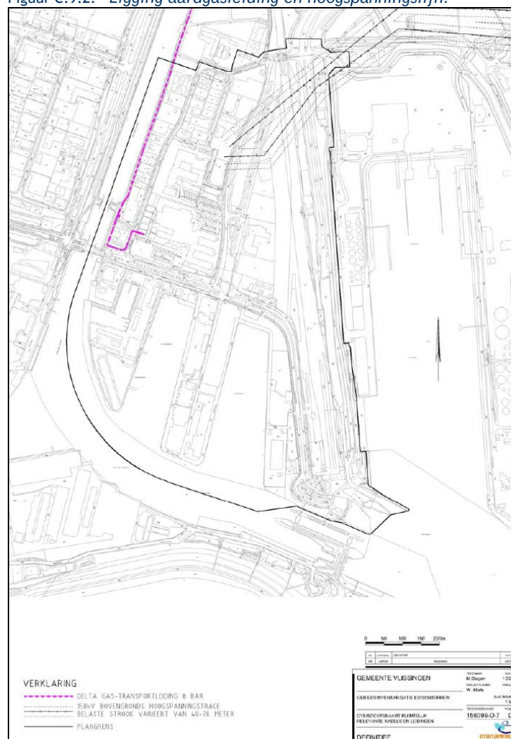
Figuur C.9.2: Ligging aardgasleiding en hoogspanningslijn.
