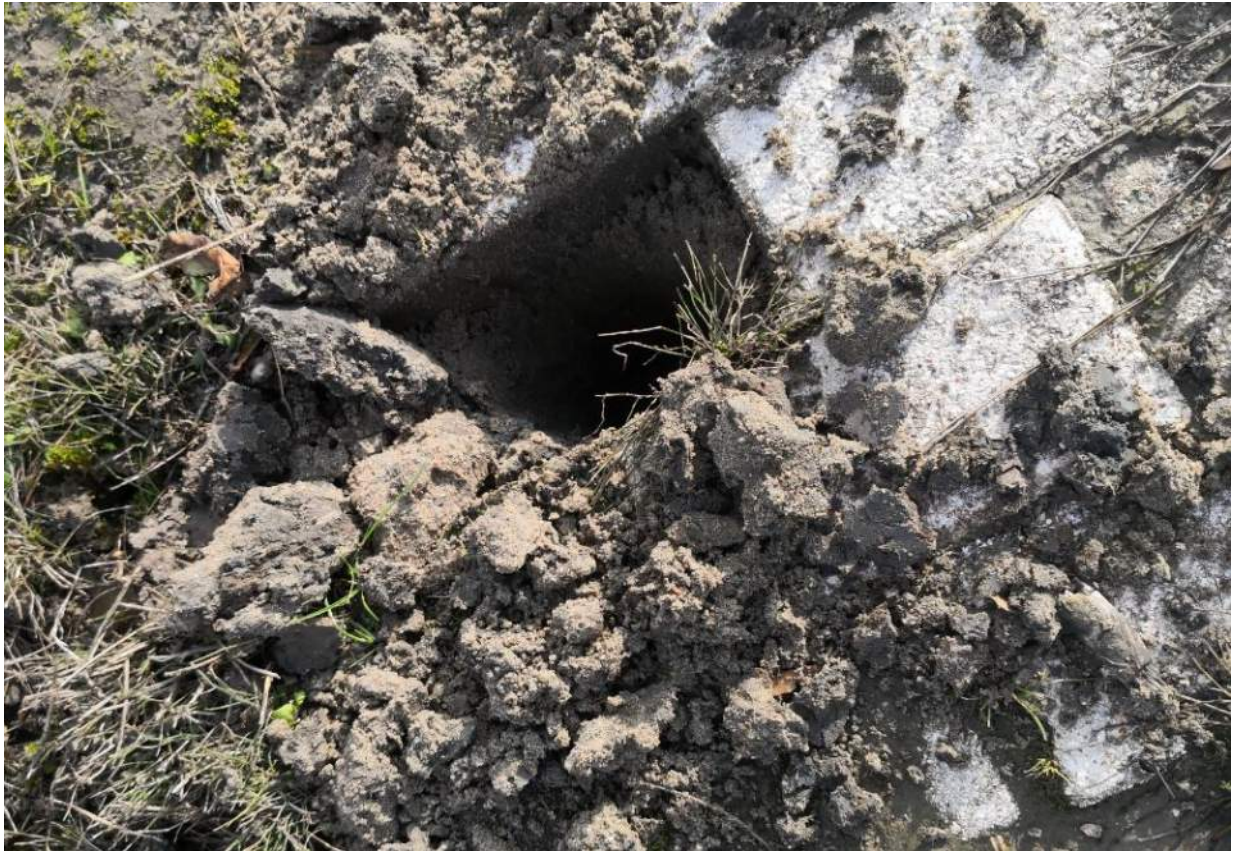
Foto 13: proefboring onder de klinker verharding met daaronder straatzand.
