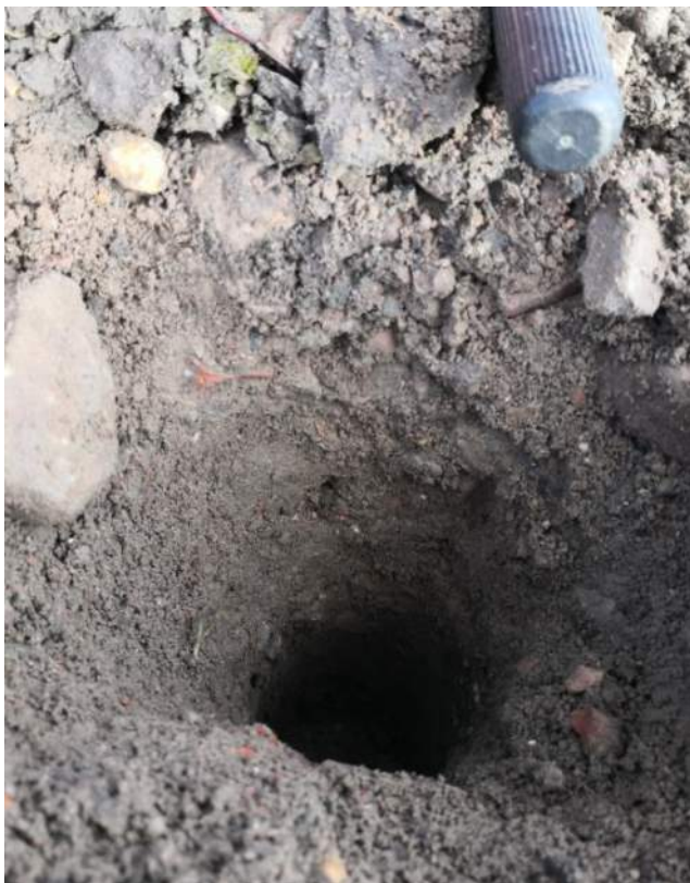
Foto 11: proefboring aan de oost zijde door de puinverharding van circa 25 cm dik
