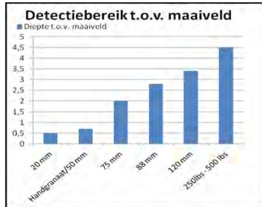
Figuur 3. Passieve realtime oppervlakedetectie met een Vallon VX1 Magnetometer en een staafdiagram waarop het maximale detectiebereik (m 1 – maaiveld) per kaliber.
