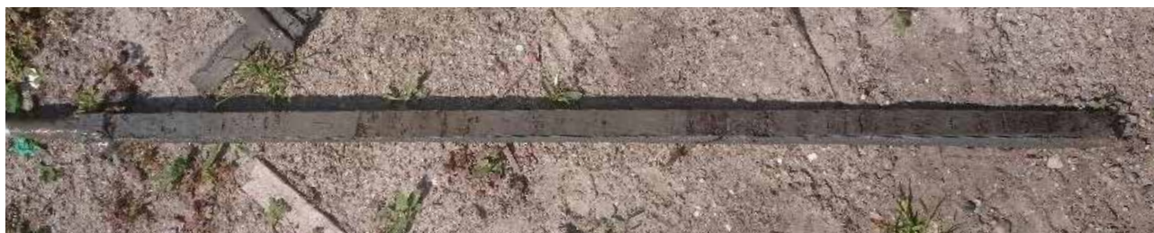
Fig.8 Boring 2 - niveau 270-370 cm onder maaiveld
