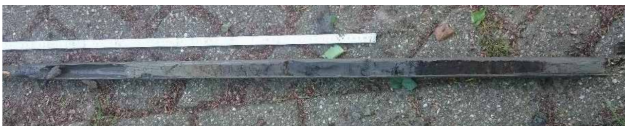
Fig.9 Boring 3 - niveau 175-250 cm onder maaiveld
