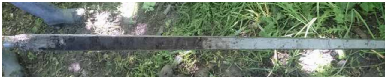
Fig.10 Boring 4 - niveau 140-225 cm onder maaiveld
