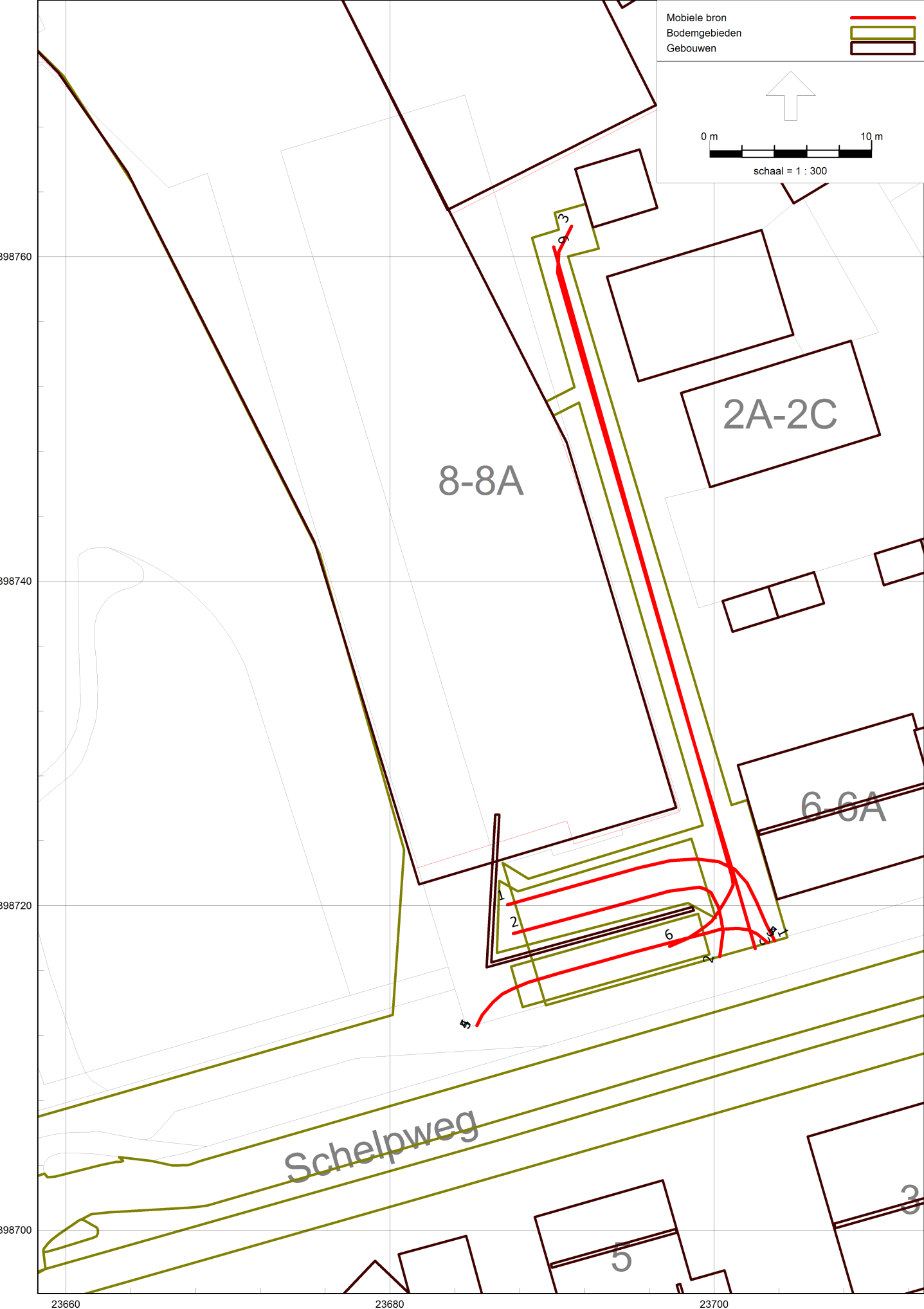
Figuur 3: overzicht van het akoestisch rekenmodel met de ligging van de mobiele bronnen
