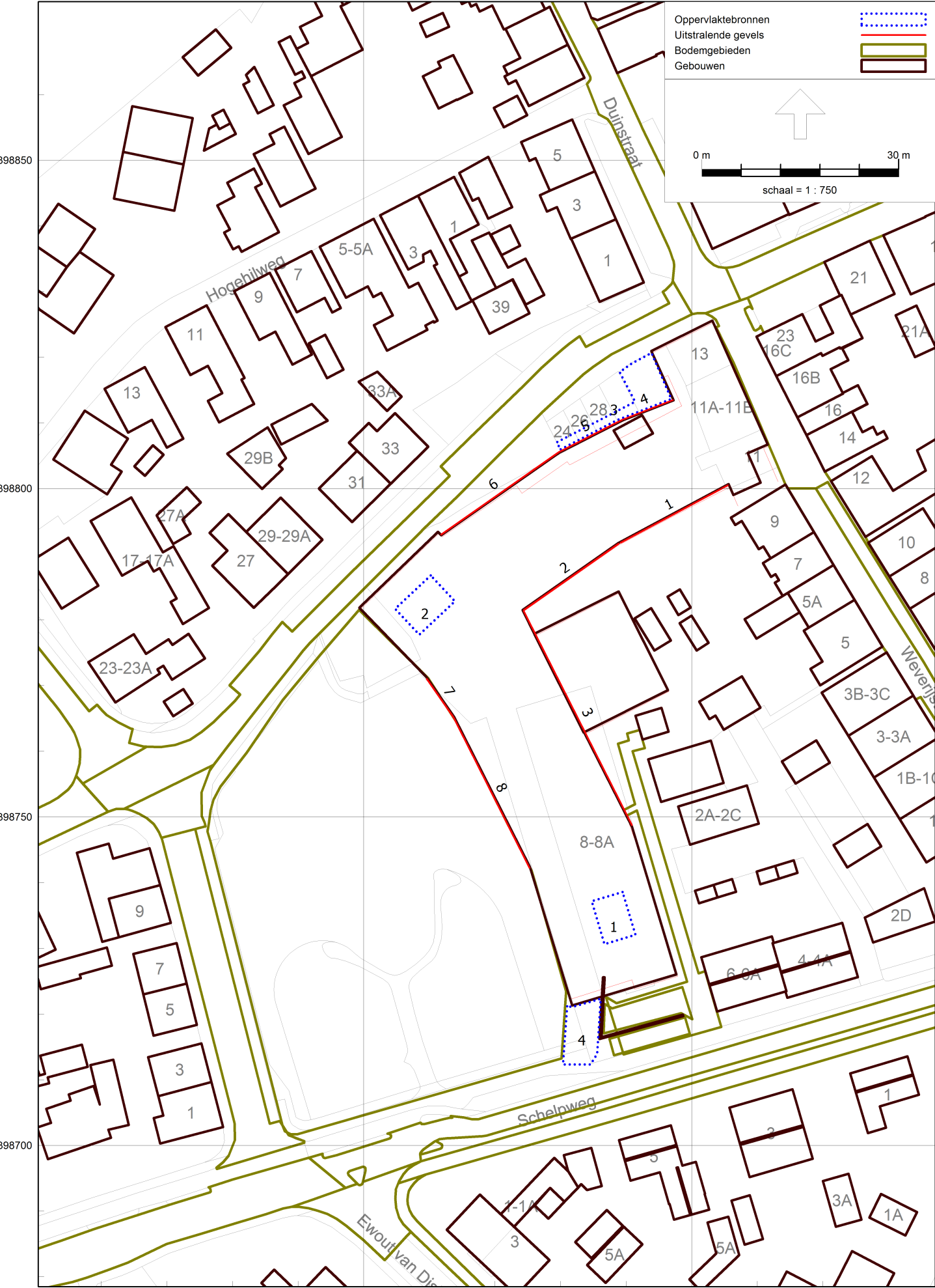
Figuur 5: overzicht van het akoestisch rekenmodel met de ligging van de oppervlakte- en gevelbronnen Rho - Rotterdam
