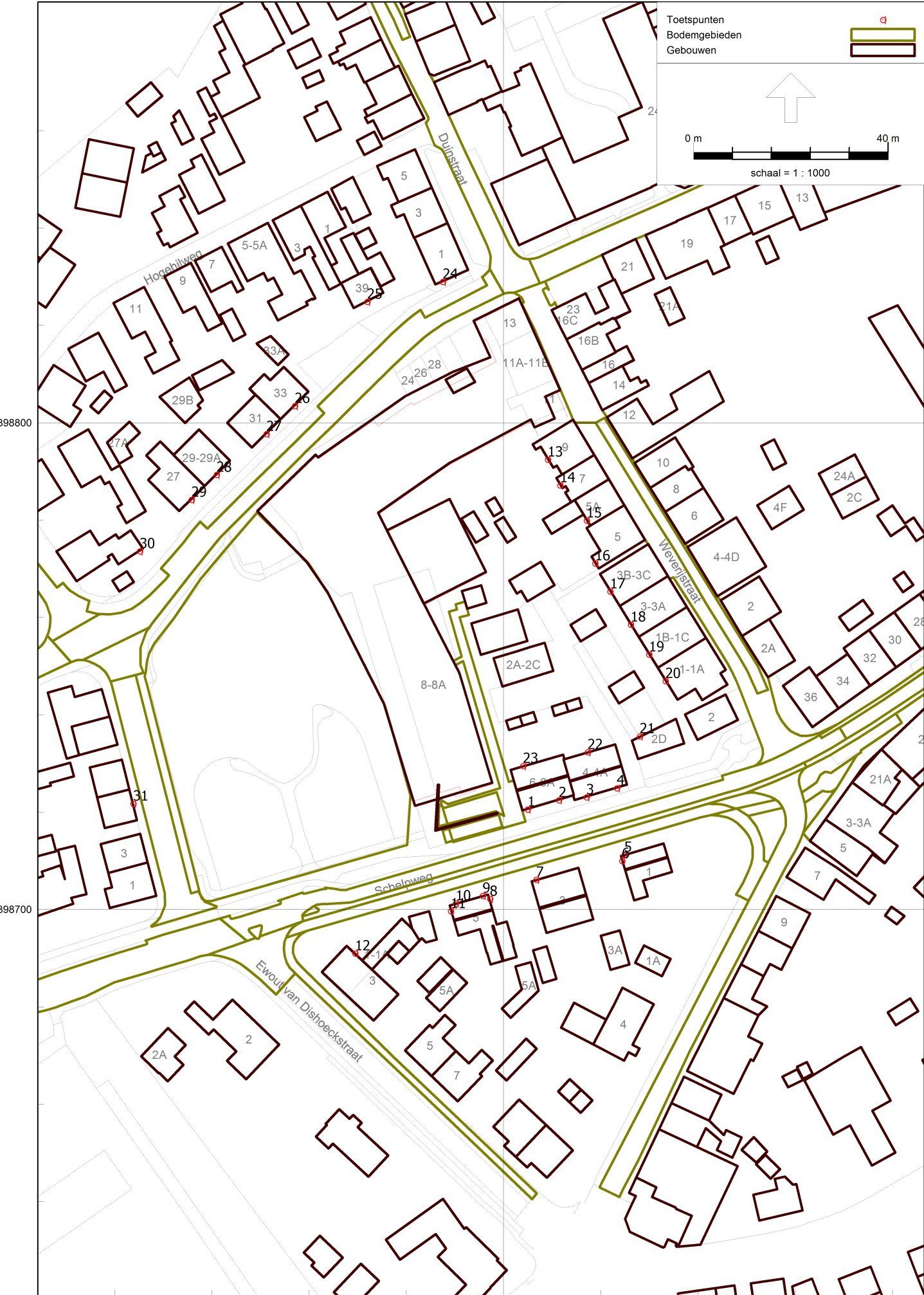
Figuur 2: overzicht van het akoestisch rekenmodel met de ligging van de rekenpunten
