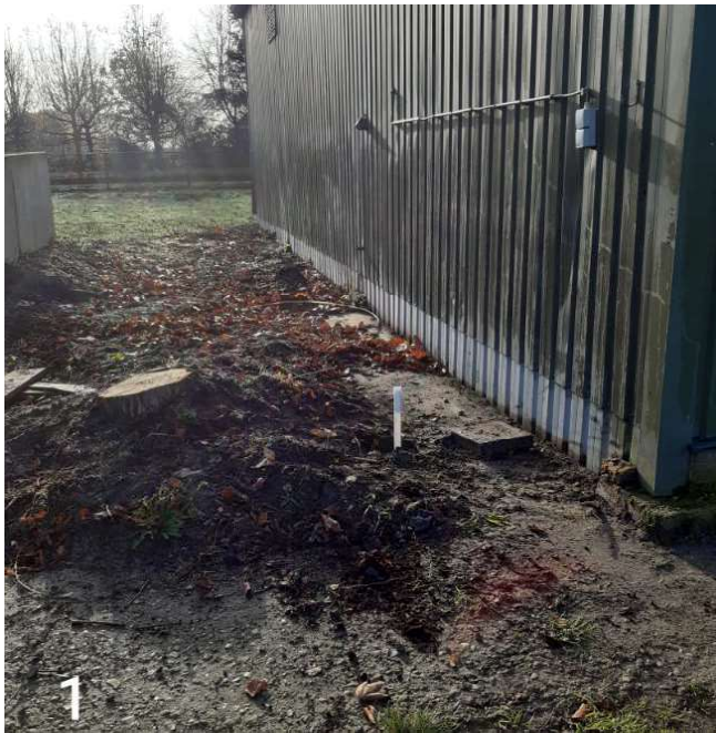
Foto 1: peilbuis 1 ter plaatse van voormalige bovengrondse HBO tank
