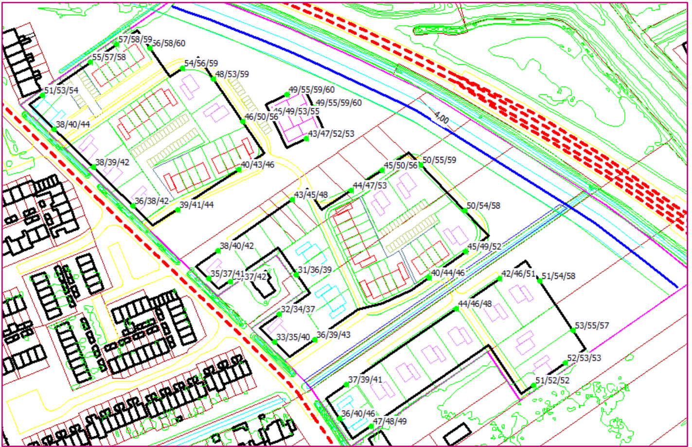
Figuur 5.5 Berekende geluidbelasting op bouwvlak L_{den} in dB vanwege N286, exclusief aftrek artikel 110g Wgh met geluidwal
