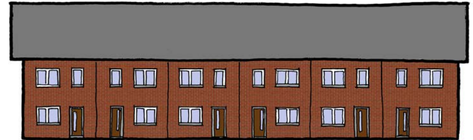
seriematig bouwsysteem met repeterende gevel
