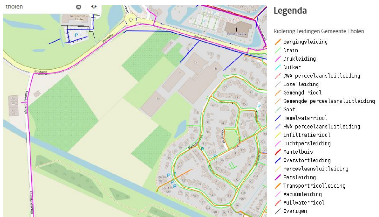
Figuur 2-11: Overzicht riolering huidige situatie
