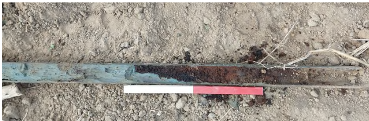
Afbeelding 7. Foto van de erosieve/schuine top van het veenpakket in boorpunt 33 (bron: Antea Group).
