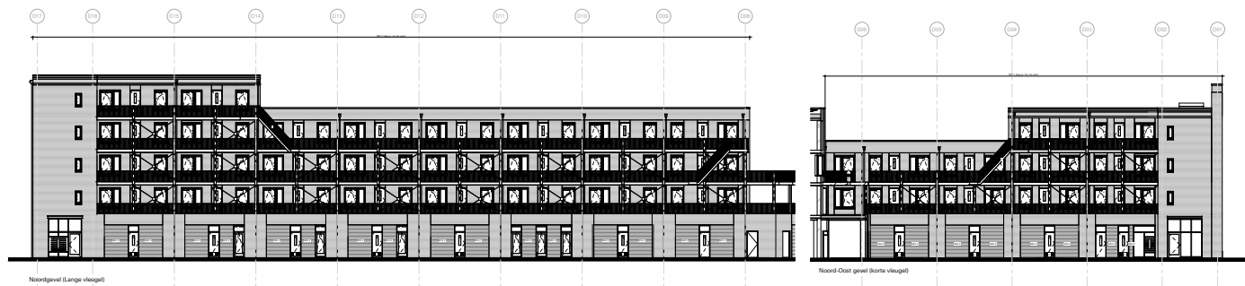
schaduwzijde begane grond bergingen / verdieping galerijen
