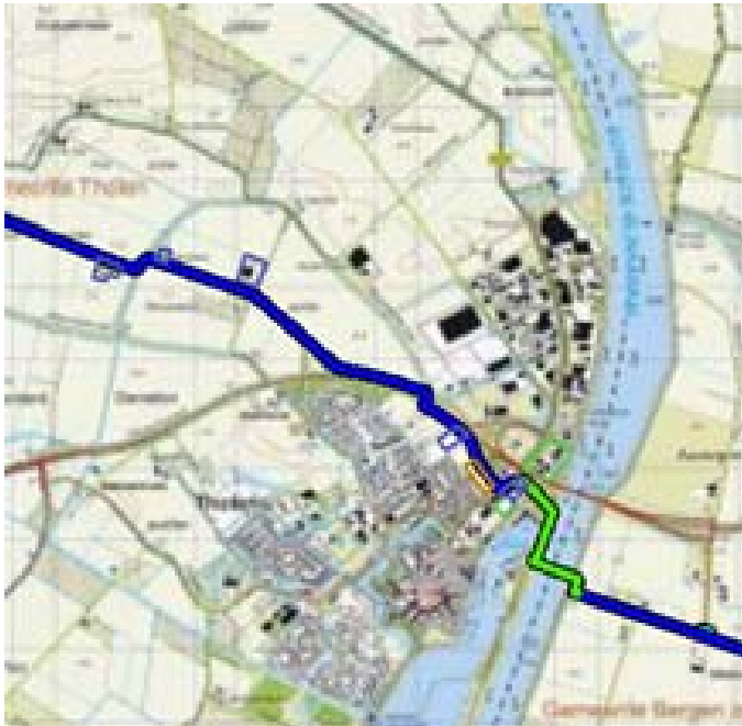
Figuur 5.5 Kilometer leiding behorende bij de maximale overschrijding van de FN-curve voor Z-525-02 van N.V. Nederlandse Gasunie
