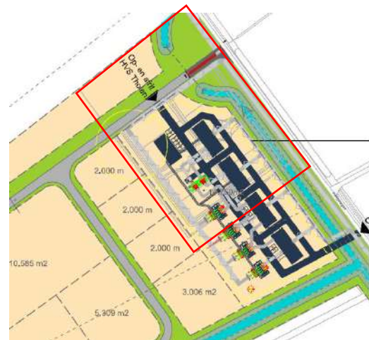
Figuur 2: Toekomstige situatie hoogspanningsverdeelstation (rode omkadering) Bron: Opdrachtgever
