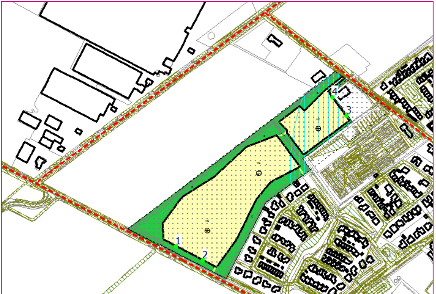
Figuur 4.1 Uitsnede rekenmodel met rijlijnen, bodemgebieden en toetspunten
