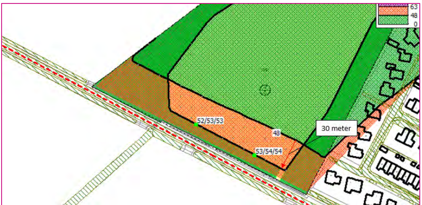
Figuur 5.1 Berekende geluidbelasting L_{den} in dB vanwege de route Zoetwaterweg – Stoofweg en de geluidcontouren
