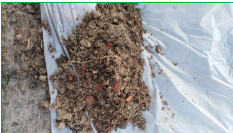
Foto 6. Opgeboord bodemvreemd maar asbestonverdacht materiaal boring 10
