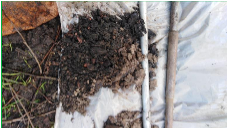
Foto 5. Opgeboord bodemvreemd maar asbestonverdacht materiaal boring 08
