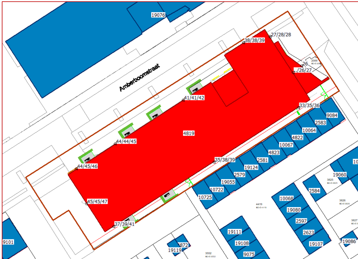
Uit bovenstaande rekenresultaten kan worden afgeleid dat de geluidbelasting op alle gevels van de nieuwbouw voldoet aan de voorkeursgrenswaarde van 48 dB uit de Wet geluidhinder.
