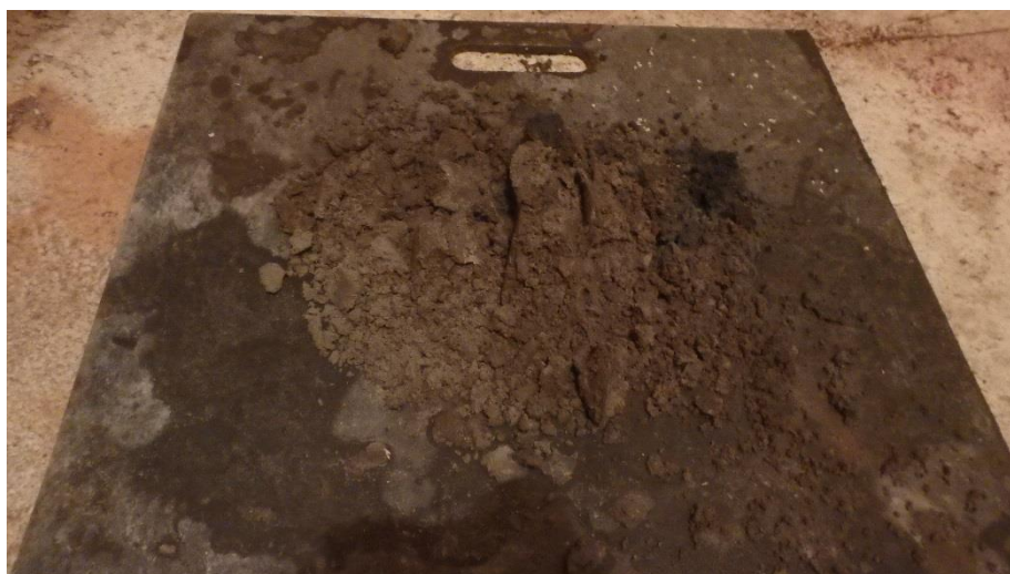
foto 9: boring 303, bodemopbouw tot 50cm-mv (- richting)
