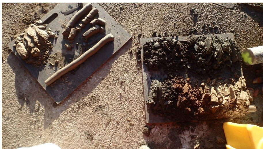
foto 12: Boring 403, bodemopbouw tot 350cm-mv (- richting)
