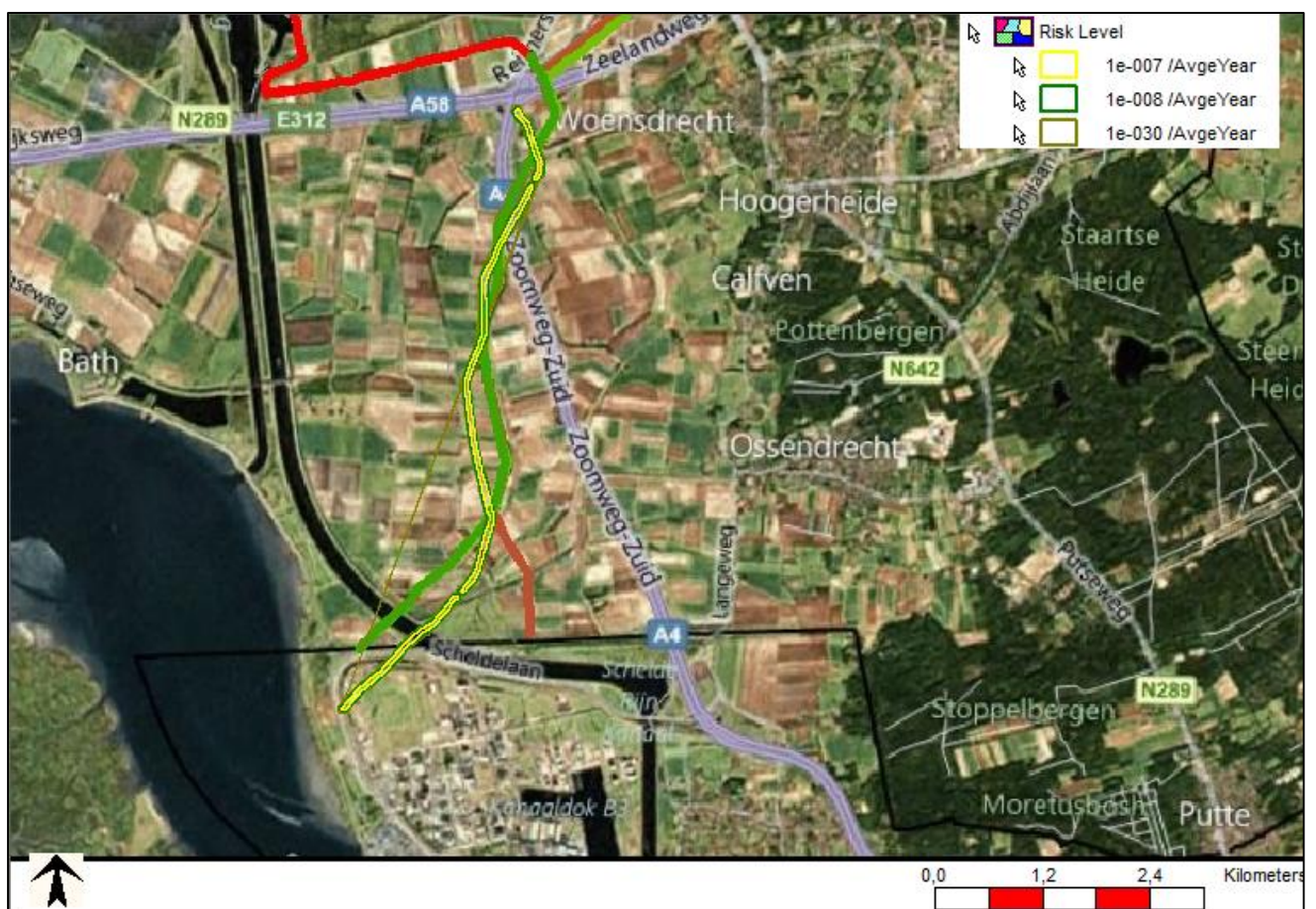
Figuur 12: Traject 3, plaatsgebonden risico koolmonoxideleiding
