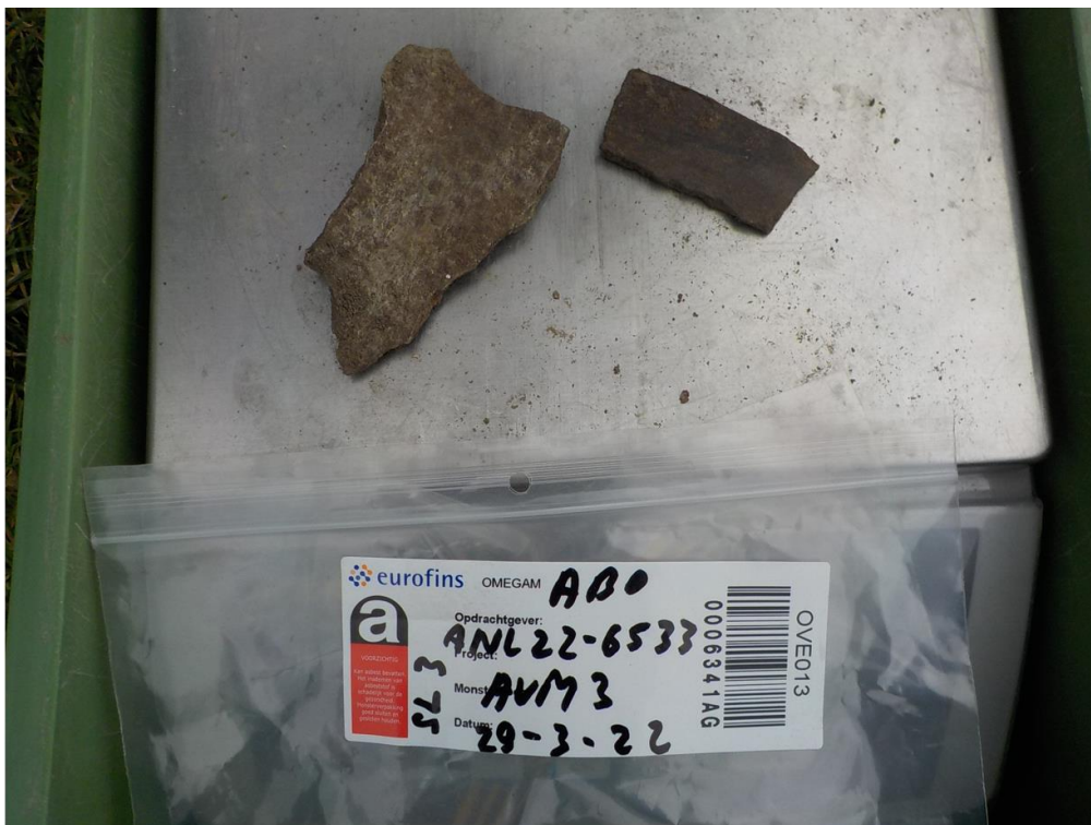
Foto 6: Asbestverdacht materiaal SL3
