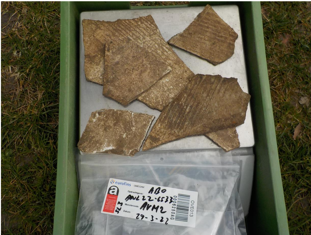
Foto 5: Asbestverdacht materiaal SL3
