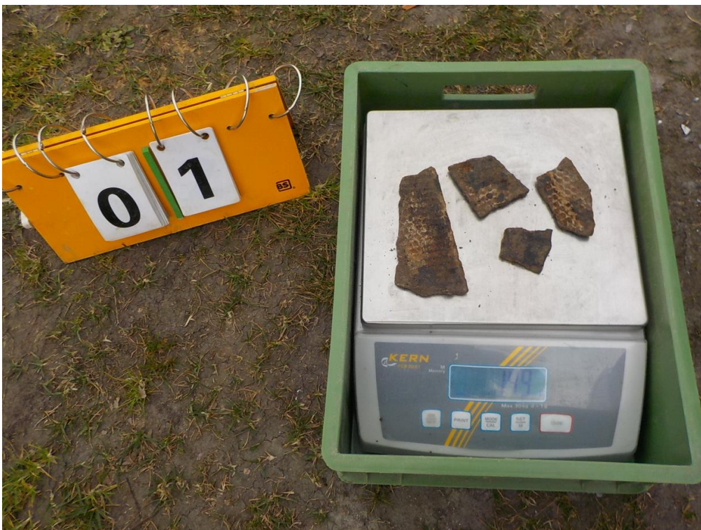
Foto 2: Asbestverdacht materiaal SL1
