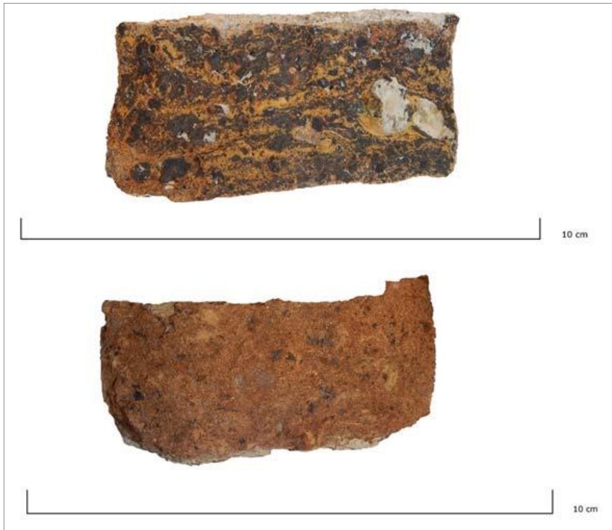
Afbeelding 12 Bakseldetails van de bakselstalen van de site Industrieel museum. Boven: versinterd appelbloesembaksel met gemêleerde donkergrijze en oudgele kleuren van de baksteen uit vondstnummer 30. Onder: normaal, onversinterd appelbloesembaksel met gemêleerde oudroze en oudgele kleuren en donkere ijzerspikkels van de baksteen uit vondstnummer 32.
