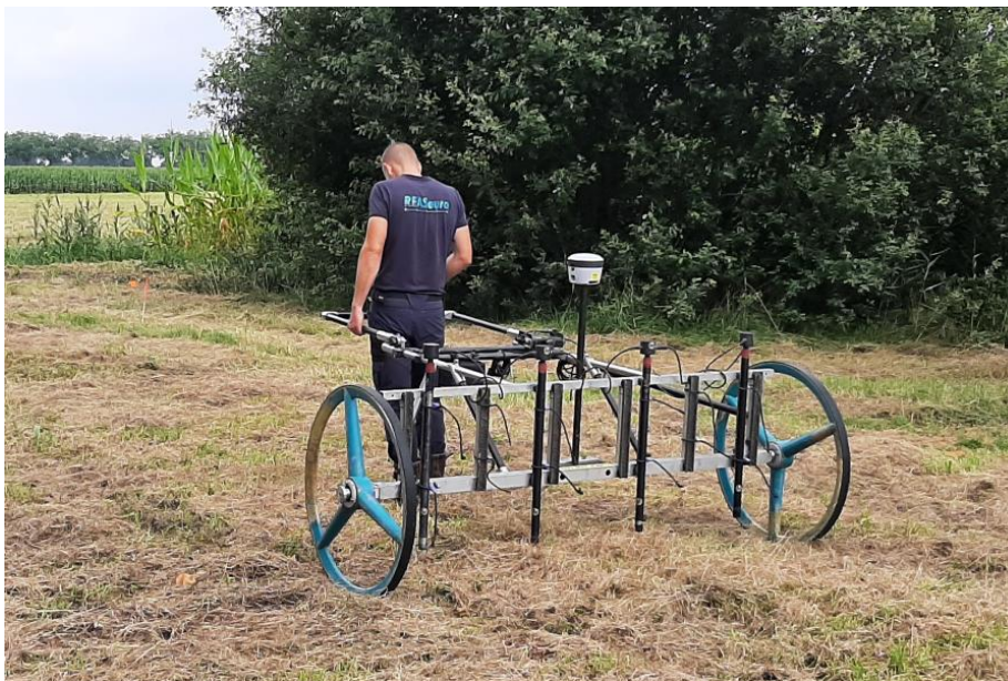
Figuur 2: Computerondersteunde oppervlakedetectie (COOD) met Vallon meetsysteem (bron: foto REASeuro).
