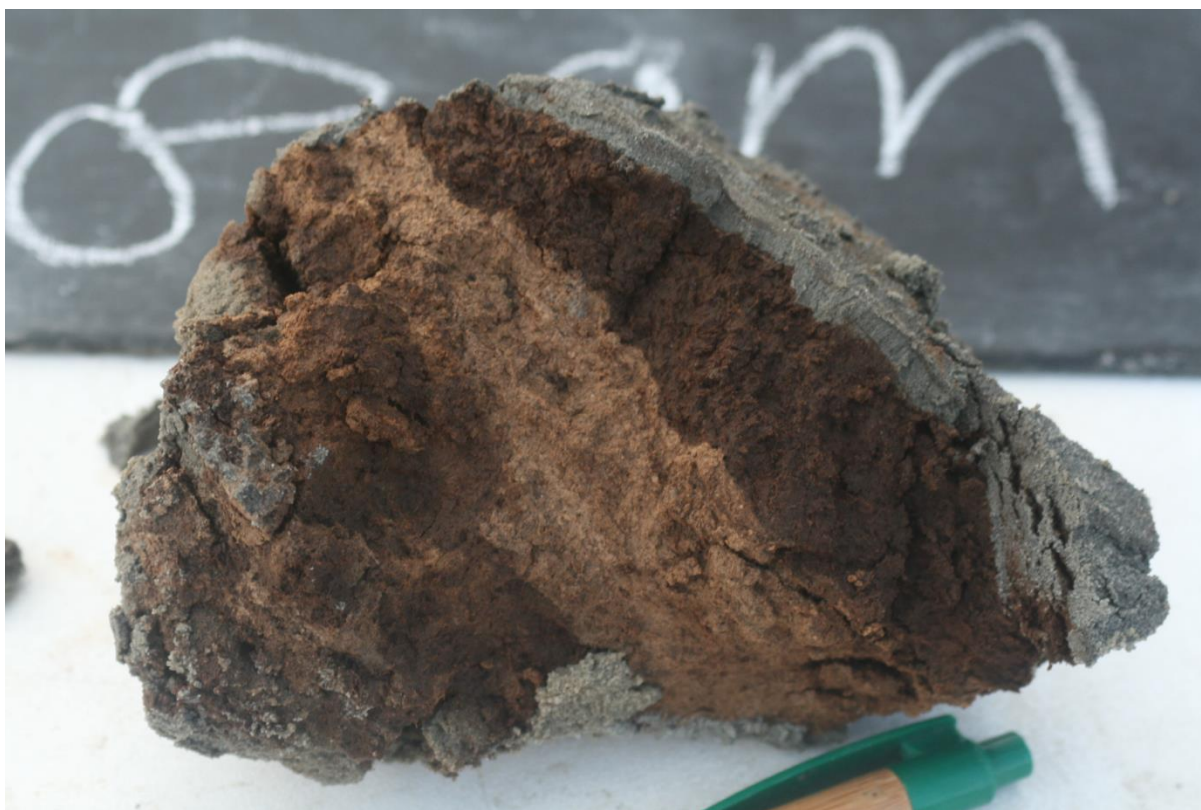
Foto 18. Detailfoto van een sedimentbrok uit de boorkern A17-36 op 8-9 m-MV (zie foto 17). Het brok bestaat uit een afwisseling van amorf veen (bruin), gyttja (licht bruin) en zand gelaagd met leemlaagjes (grijs).
