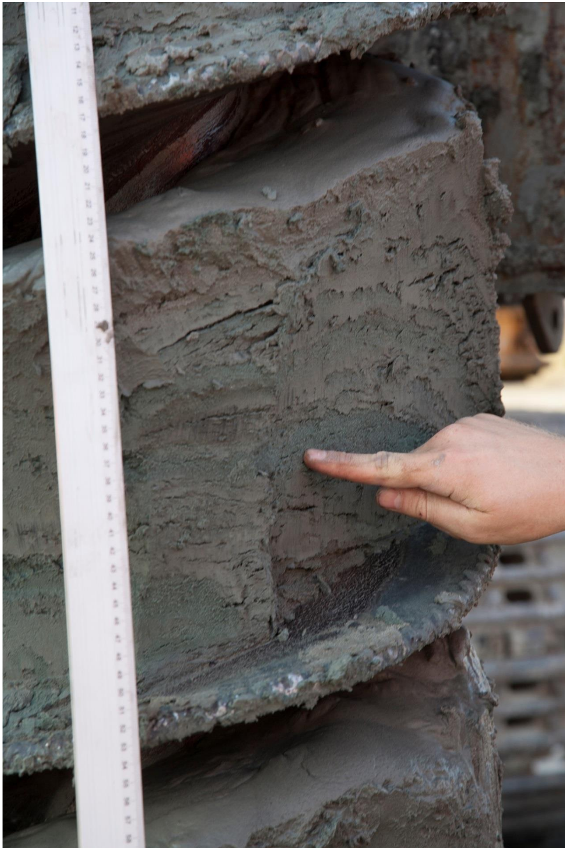
Foto 15. Humeuse klei gelaagde afzettingen van de Schelde restgeulafzettingen op een diepte van A17-41 op 6-7 m – MV. Het zand is wat groenig doordat het verspoeld glauconiet uit de dieper liggende afzettingen bevat.
