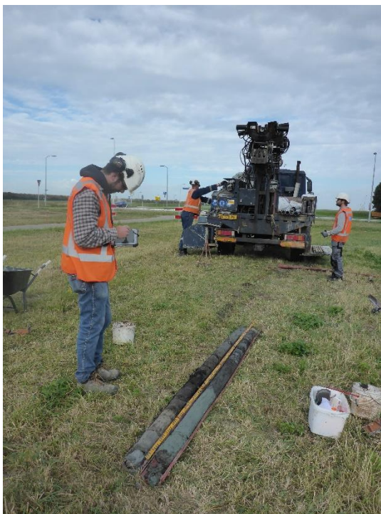
Figuur 5: beschrijving van de boringen en figuur 6 : het snijden van het jongere sediment (foto's GATE).
