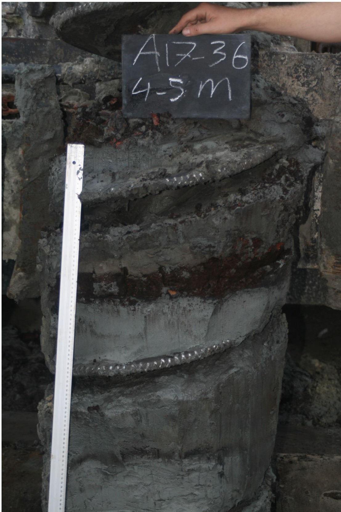
Foto 16. Verdraaide veenlaag ('verontreiniging') in de top van de Pleistocene afzettingen van boring A17-36. In de boormonsters van deze boring werd relatief veel vuursteen aangetroffen waaronder een stukje op 4-5 m –MV.
