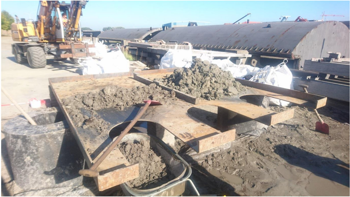
Foto 31. De zeefplaat waar twee monsterzakken per keer werden gestort. Van de zeefplaat werd het monster in de zeefkruiwagen geschoven. Foto Menno van den Berg.
