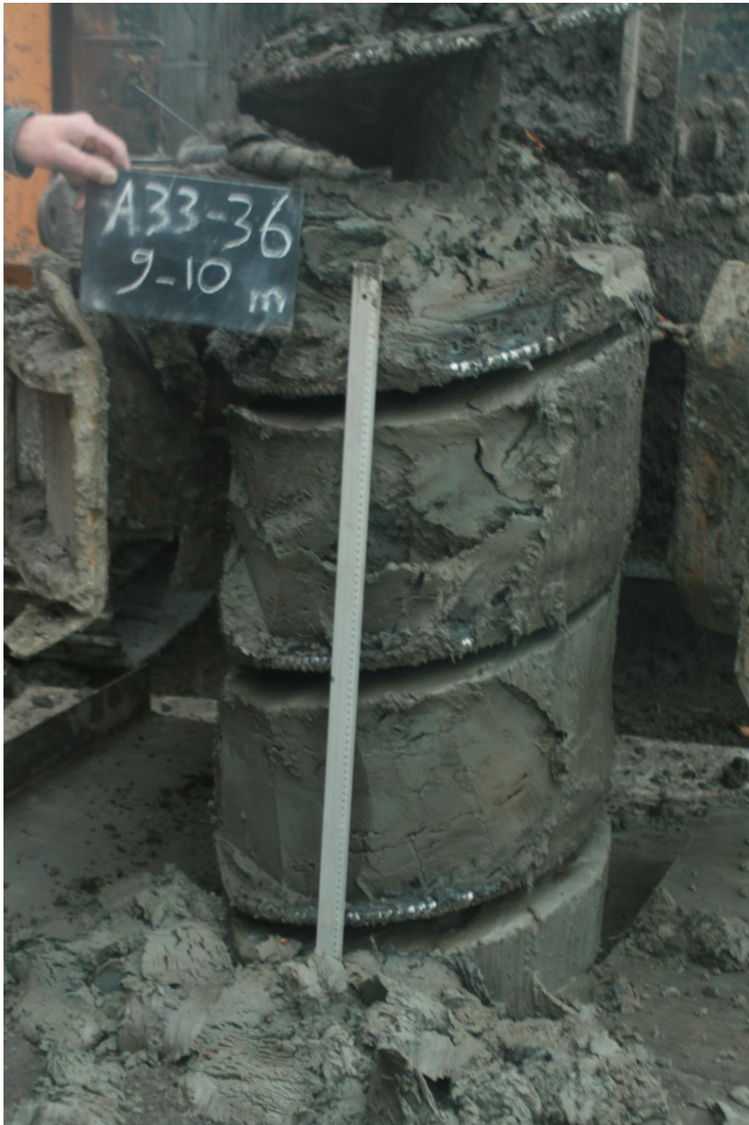
Foto 11. Opname van boring A33 boornummer 36 op een diepte van 9-10 m –MV. Op de gedraaide boorschoppen is een dunne blauwgrijze klei en ook organisch materiaal te zien. Het betreft hier stugge Sluiskilkwelderklei en veenrestanden van het Basisveen dat bij het draaiend boren omlaag is gekomen en daarmee de Plesitocene Schelde afzettingen op de diepte 9-10 m ‘stratigrafisch vervuild’.
