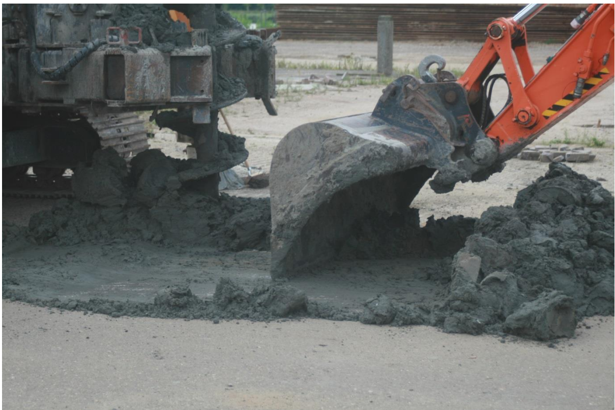
Foto 4. Het omhoog gedrukte overtollige sediment van de bovengrond wordt - voorafgaand aan de bemonstering - met de kraan verwijderd.
