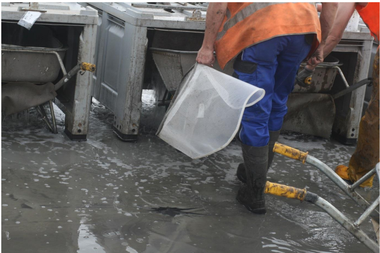
Foto 34. De gebruikte zeefkruitwagen met daarin het losse zeefnet. Het plastic zeefnet met een maaswijdte van 3 mm. Foto Menno van den Berg
