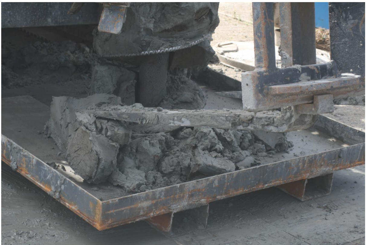
Foto 6. Per boormeter – gemeten ten opzichte van maaiveld – is het Pleistocene sediment uit de boor bemonsterd en met de heftrucktanden uit de avegaarboorschoppen gedrukt.
