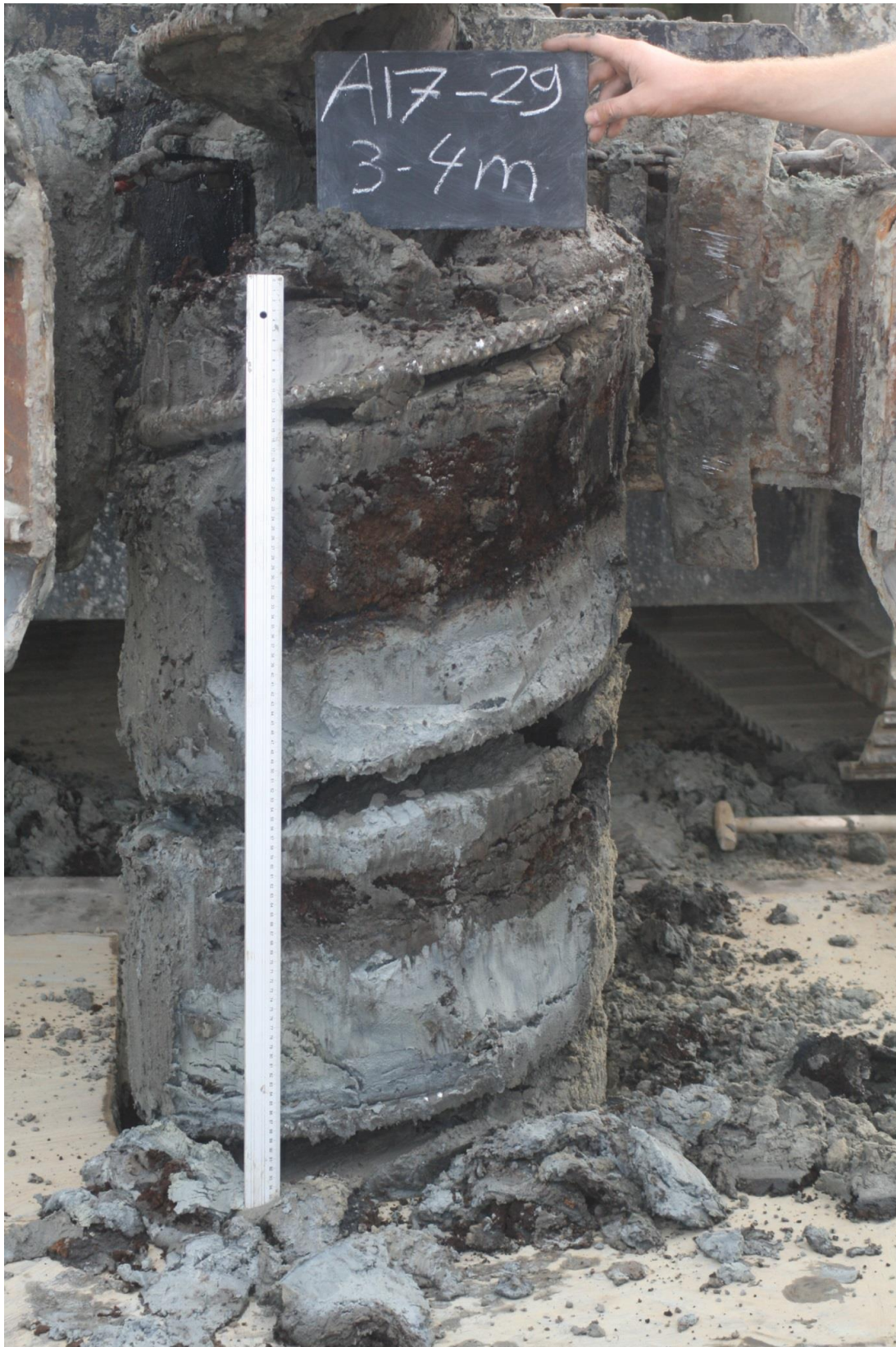
Foto 11. De bovengrond met kade-ophogingsmateriaal, Holocene klei en veen tot 3 m onder het oppervlak werd niet bemonsterd. De overgang veen - dekzand op 3-4 m onder maaiveld werd wel bemonsterd. Door het draaien van de boor werd het veen en het zand met elkaar vermengd.
