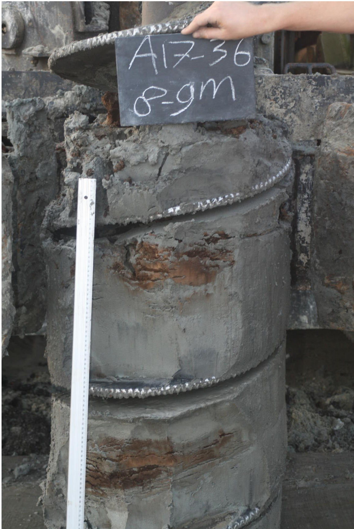
Foto 19. De boorkern A17-36 op 8-9 m-MV. De organisch rijke brokken (veen en gyttja) zitten – verstoord / ‘verdraaid’ - in de kern van gelaagd zand (gelaagdheid op humeusiteit en kleilaagjes). Ook in het boormonster van deze kern is een vuursteensplinter aangetroffen.
