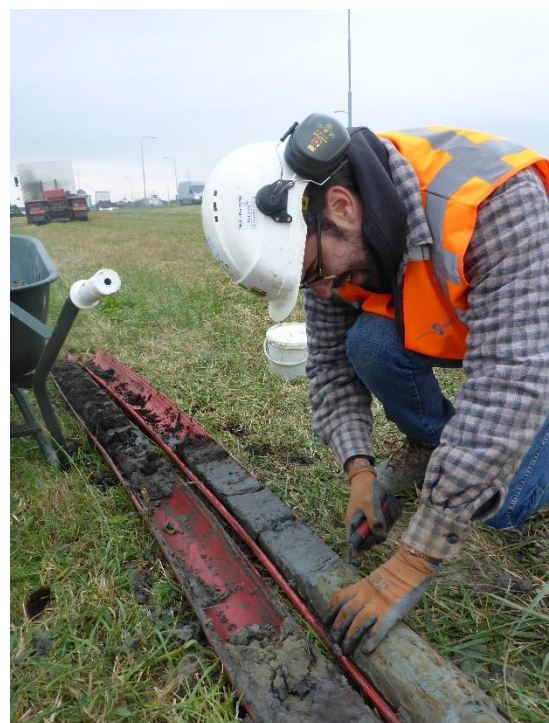
Figuur 5: beschrijving van de boringen en figuur 6 : het snijden van het jongere sediment (foto's GATE).
