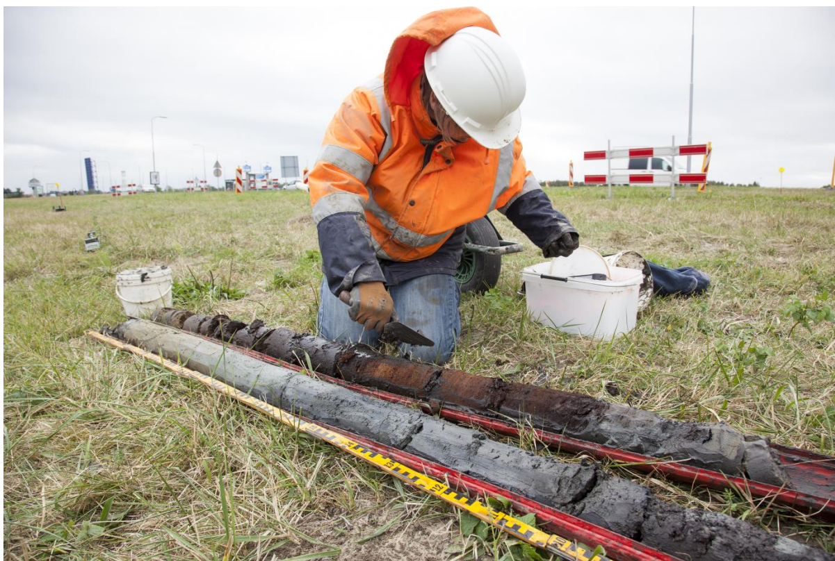
Foto 42. Bemonstering van de uitgedrukte boorkern. Foto: Nieuwe Sluis Terneuzen - Mark Neelemans Fotografie.
